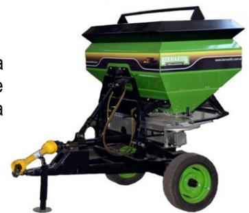
La caja de engranajes cónicos en baño de aceite comandada por una barra cardánica desde la TDF del tractor. Todo el sistema de discos y canales distribuidores están construidos en acero inoxidable. El corte de aplicación se realiza en forma hidráulica desde la cabina del tractor.
