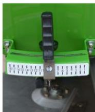
El sistema manual de regulación para la apertura y cierre de la compuerta dosificadora con escala milimétrica permite modificar en forma precisa la dosis de producto a esparcir. Un comando eléctrico a distancia desde la cabina del tractor se provee como opcional.
