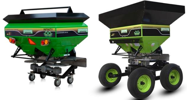
Opcionalmente montada sobre un carro (1 eje / Balancin) para trabajar como máquina de arrastre, posee la dualidad de permitir al quitarlo, fertilizar con la misma como una máquina suspendida.
